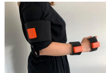
Die Sensoren übertragen die Impulse kabellos an einen Rechner.
